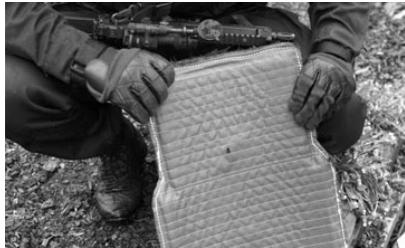
Auf 200m durchschlage sie das NATO CRISAT Referenzziel (1.6mm Titan und 20 Lagen Kevlar) problemlos, schreibt die RUAG auf ihrer Homepage über die Penetrator-Munition. Foto RUAG
